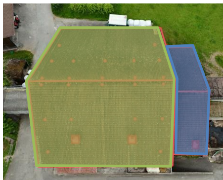
Bild 1: Dachverstärkung Haupt- und Anbaudach
